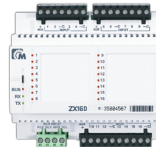
ZX16D 16 Zónás/bemenetes bővítő modul
